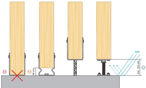
Ukotvení sloupů dřevěné zahradní stavby k betonovému podkladu
