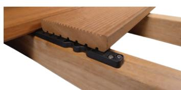
Terasové kluzáky jsou zespodu připevněny k palubkám. A kluzáky jsou k podkladu fixovány v přední části a zadní části kluzáku jsou kluzně uloženy pod předcházejícími palubkami. Mezi spodní konstrukcí a terasovou palubkou vzniká mezera 10 mm, která usnadňuje provětrávání terasy.
