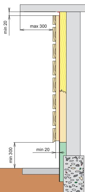
Schéma minimálních a maximálních odstupů
