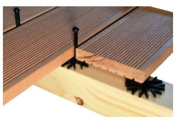
Terasová hvězda sestává ze dvou dílů – hvězdy a trnu. Trn se používá opakován, vkládá se do otvoru v podkladu a jeho geometrie umožňuje natočením celé hvězdy výběr ze čtyř různých šírek mezér (6, 7, 8 a 9 mm). Po
