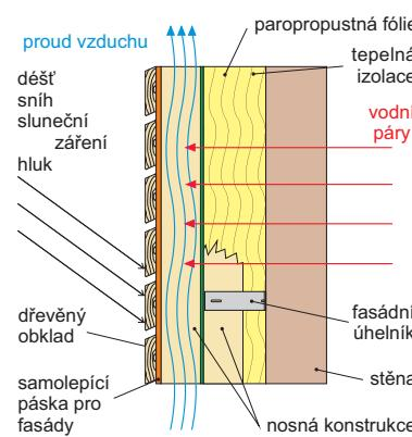
Schéma konstrukce opláštěné horizontálně orientovaným obkladem.
