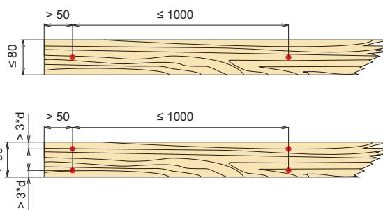
Schéma minimálních a maximálních vzdáleností spojovacího materiálu u fasádních profilů
