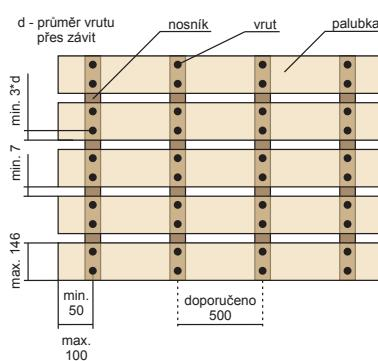
V případě viditelného připojení doporučujeme terasové palubky předvrtávat. U vrutů z austenitické nerezové oceli je to nutností, u vrutů z martenzitické nerezové oceli zejména z estetických důvodů. Pro předvrtání se zahloubením
