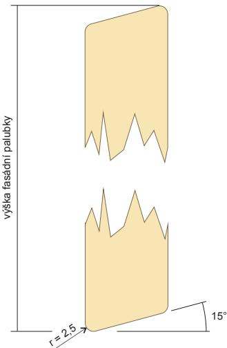
Úprava konců fasádních palubek při vertikální orientaci
