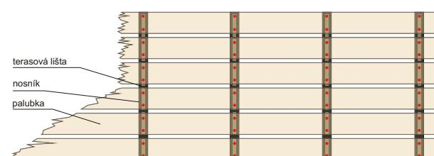
vytváří 7 mm širokou mezitu mezi nosníkem spodní konstrukce a spodní stranou terasové palubky. Vruty tak mají v mezeře prostor na reakci na namáhání, které je v příčném směru terasové palubky obzvlášť silné. Dalším plusem použití terasové lišty je rychlý odvod srážkové vody a rychlejší vysychání spoje, prodlužuje se tak životnost terasy.
