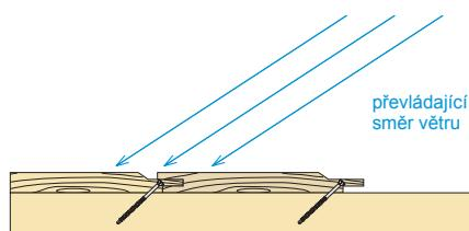
Vertikální orientace fasádních palubek s perem a drážkou, pero musí směrovat proti směru převládajícího směru větru. Neviditelné připojení vrutu RAPITEC® BSP do lišt
