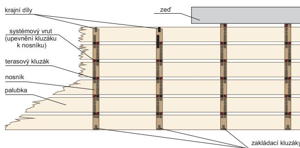
Systém sestává z terasových kluzáků, zakládacího a krajního dílu a systémových vrutů. Systém zajišťuje, že při bobtnání a sesychání terasových palubek nejsou spoje namáhány na stříh.
