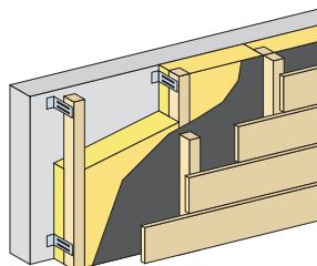
Nosná konstrukce tvořená svislými nosníky na ocelových úhelnících
