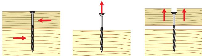
Základem pro dlouhodobé fungování spoje je tedy spojovací materiál s garantovanými vysokými hodnotami mechanických vlastností, výběr správné geometrie vrutu a zvolení správného průměru a délky.
