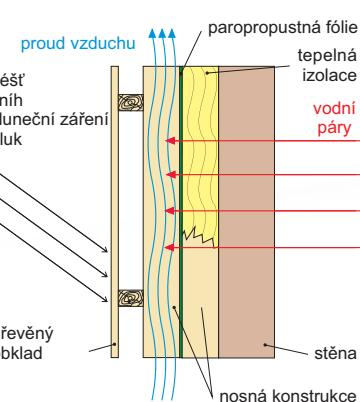
Schéma konstrukce opláštěné vertikálně orientovaným obkladem.
